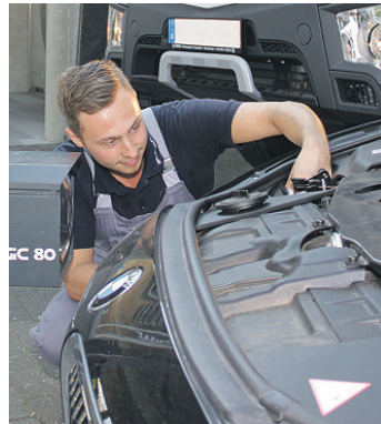
Kfz-Mechatroniker Tiemo Lucht testet mit einem speziellen Scheinwerfereinstellgerät, ob das Licht am Fahrzeug richtig funktioniert.
